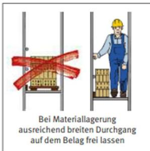
Bei Materiallagerung ausreichend breiten Durchgang auf dem Belag frei lassen
