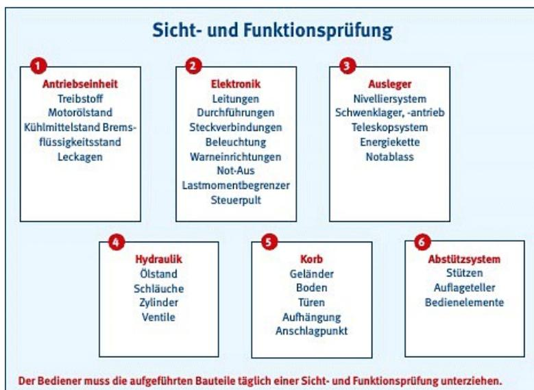
Quelle: Tägliche sicht- und Funktionsprüfung aus: Richtlinie: DGUV Information 208-019: Sicherer Umgang mit fahrbaren Hubarbeitsbühnen (bisher BGI 720) – Bild 5-1, HAUFE Arbeitsschutz Office Gold
